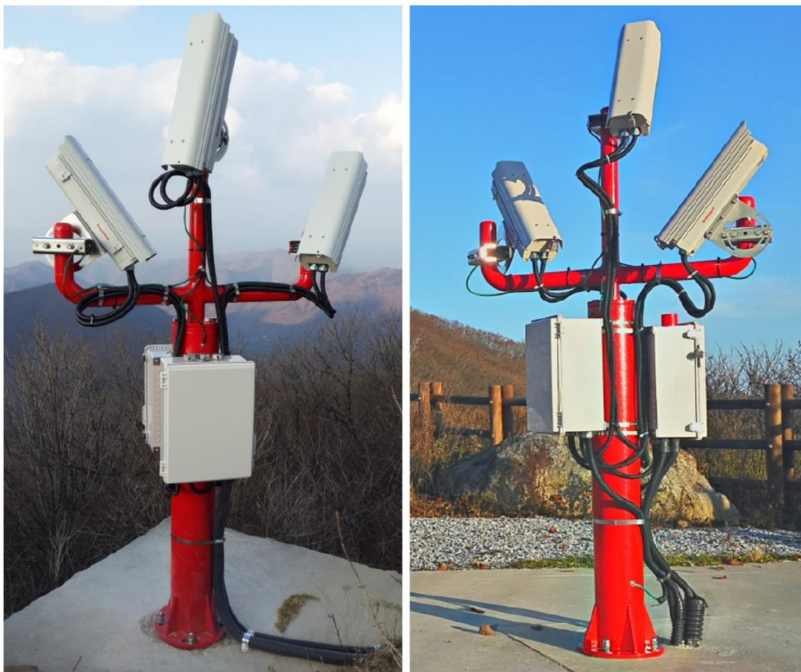
**Rys. 6A:** Dwustanowiskowy system kamer monitorujących, służący do optycznej detekcji meteorów oraz bolidów w Korei Południowej (lewy panel: stanowisko BOAO; prawy panel: stanowisko SOAO). Rysunek pochodzi z pracy Hinse i in. (2017, Rys. 2).
