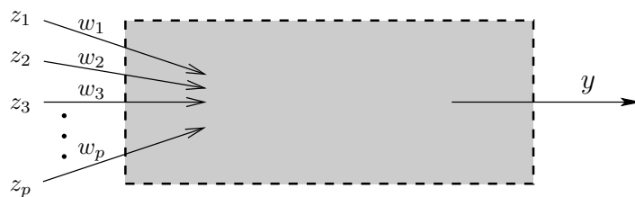
Rysunek 10: Ogólny model neuronu. Neuron charakteryzowany jest przez p wejść i jedno wyjście ( y ), jego wnętrze może przybierać różne formy.
